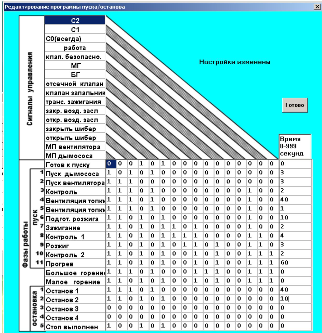
3.3.2 Единица, установленная напротив выбранного исполнительного механизма, означает, что данное устройство используется (включено).
