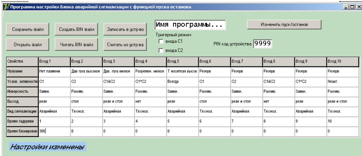
3.2.2 На следующем рисунке рабочего окна программы показано включение триггерного режима для входов «C1», «C2».
