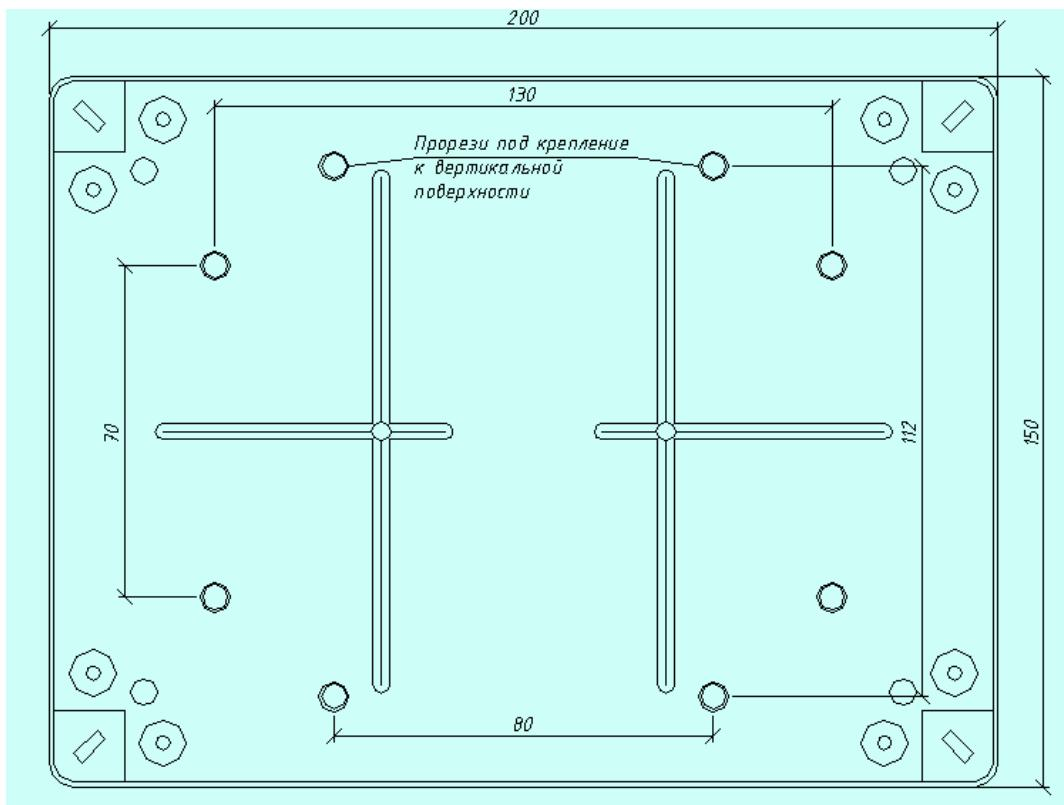
Рисунок В.1 - Габаритные и установочные размеры блока «БАКС-10М»
