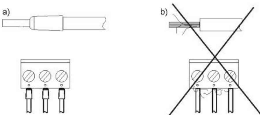
Рис.9 Защита концов провода: а) правильная, б) неправильная
