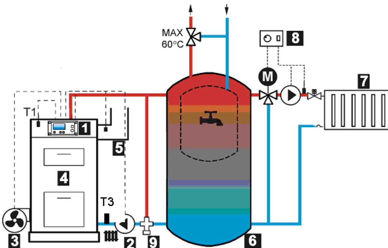
Рис. 6 Гидравлическая схема с тепловым буфером, где:
