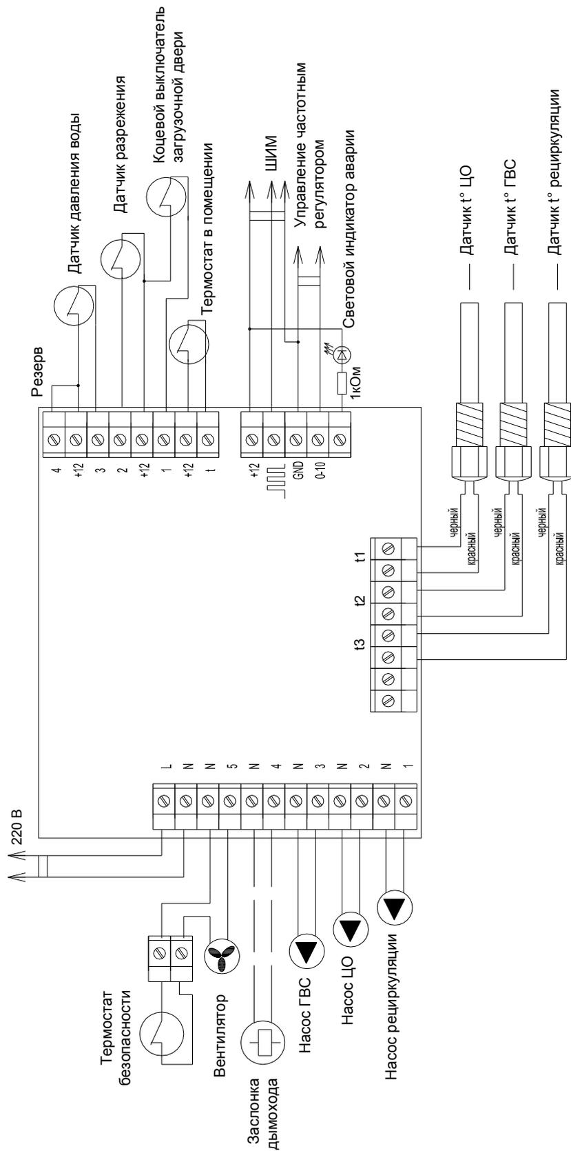
Рис. 10 Схема электрических соединений с внешними устройствами, где:
